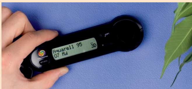
Колориметр “Buntstift” – высокотехнологичный прибор для измерения цвета прямо на месте
