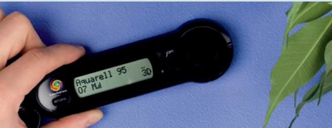
Колориметр “Buntstift” - высокотехнологичный прибор для измерения цвета прямо на месте
