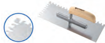
Edelstahl-Zahnkelle Holo-Top 280 x 130 mm, Stärke 0,7 mm Mit spezieller Zahnung zum Auftragen von Kleber z.B. bei Fliesen- und WDVS-Arbeiten. Vermeidet Hohlräume unter den Belägen.
