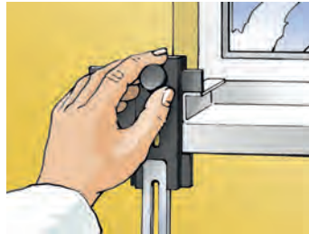
3. Festlegung der Überlappung zwischen Fensterbankoberkante und Dämmmaterial
