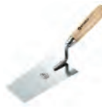
Edelstahl-Berner-Putzkelle Profi-Qualität Mit 9 mm Angel, Blattstärke 0,7 mm, GS-geprüft durch VPA, nach DIN 6441 gefertigt, mit Holzgriff.
