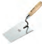
Edelstahl-Stuckateur-Kelle Profi-Qualität Mit 9 mm Angel, Blattstärke 0,7 mm, GS-geprüft durch VPA, nach DIN 6440 gefertigt, mit Holzgriff.
