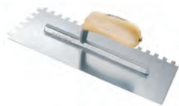
Edelstahl-Zahnkelle Spezial 350 x 130 mm, Stärke 0,7 mm. Zum gleichmäßigen und großflächigen Auftragen speziell von Armierungskleber. Mit Ergogriff für gute Kraftübertragung. Besonders rationelles Arbeiten im Verbund mit Edelstahl-Glättekelle Spezial bei WDVS-Arbeiten.
